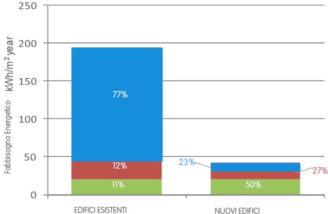
L'isolamento termico riduce enormemente i fabbisogni per trasmissione.
